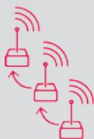
для увеличения дальности управления применяется уникальное решение: ретрансляция сигнала — каждый приёмник, принимающий управляющий сигнал, автоматически передаёт его дальше.
